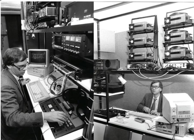
Figure 1 : l'infrastructure diaporama AVL : 6 projecteurs Kodaks SAV – mono écran
