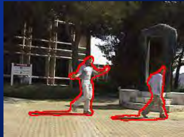
Exemple de segmentation d'une scène mobile par un encodeur MPEG4: reconnaissance des personnages en mouvement relatif.
